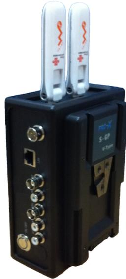
4G-Live 双卡直播终端运用多信道捆绑技术可以同时连接 2 个 3G/4G 移动蜂窝、WiMAX 和 Wi-Fi 无线链路。多卡直播终端使用 H.264 High Profile 视频编码技术，能够在有限带宽内提供最高可达 1080P 的高清视频信号传输。接口提供包括高清 SDI 和模拟 A/V 输入，并支持双向语音对讲功能。
